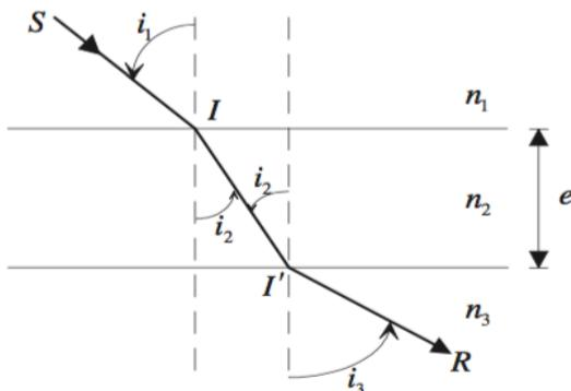
Figure 3 : Marche d'un rayon lumineux dans une lame à faces parallèles ( $n_3 < n_1 < n_2$ ).
