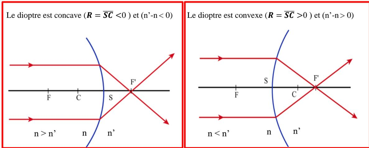
Nous représentons la réfraction d'un faisceau de rayons parallèles à l'axe du dioptre suivant que le dioptre est convexe ou concave et que  $n_1$  est supérieur ou inférieur à  $n_2$ .
